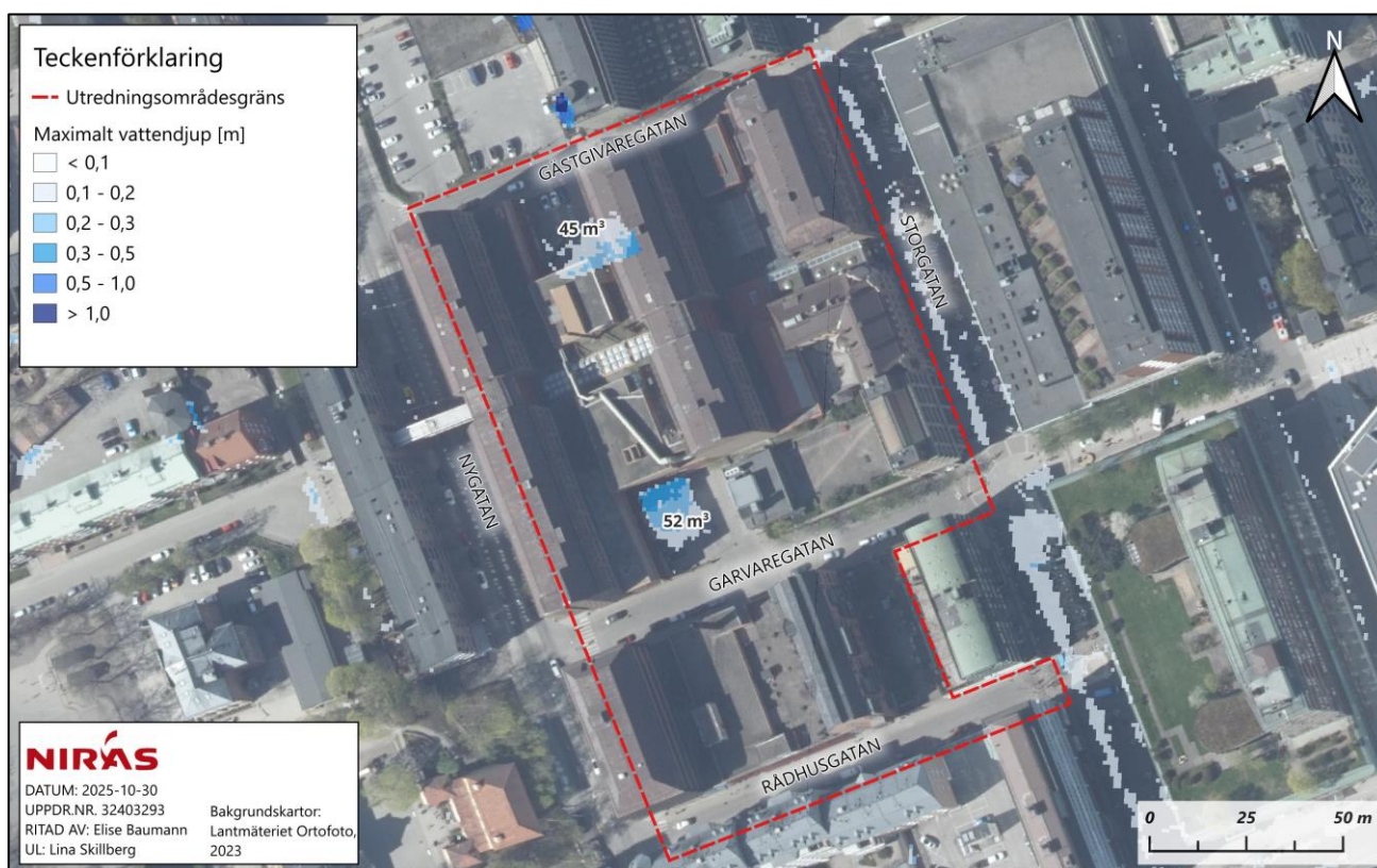
Figur 4.8 Maximalt vattendjup vid befintlig situation. Resultat från dynamisk simulering i SCALGO DynamicFlood.
