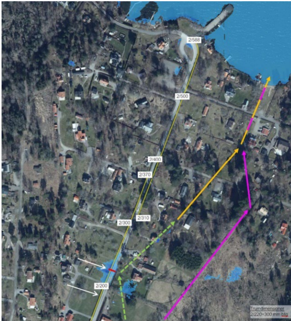
Figur 54 Illustration av läge för trumma där Trafikverkets vägdagvatten leds till kvartersmark. Källa: Dagvattenutredning gång- och cykelväg etc. Pontarius, 2024.
