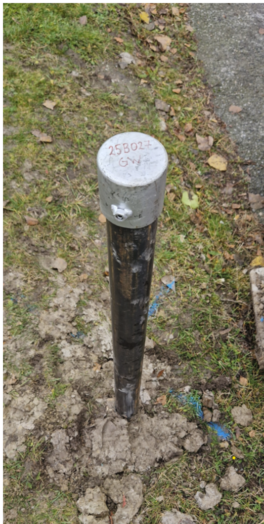
Figur 2. Installerat miljörör i 25B027, med skyddande 2 tums-rör för uppstick PEH-rör.
