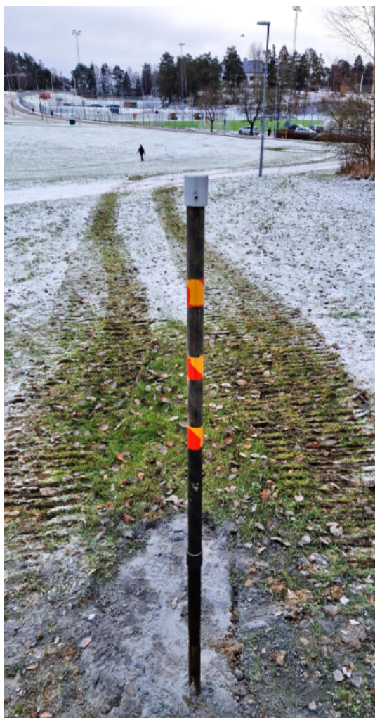
Figur 2. Installerat grundvattenrör i 25B011.
