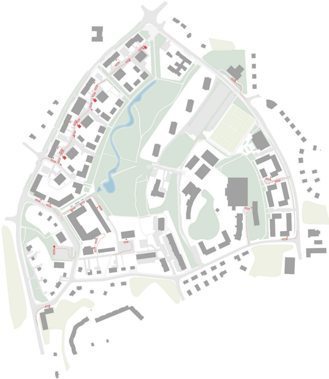
Figur 24 Illustration över sopbilens väg, angöring och miljörum inom planområdet, LAND och Fritzell & Pantzar, 2026
